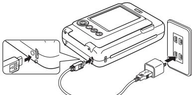
将附带的 USB 数据线的一头连接相机，另一头连接智能手机等的 USB 电源适配器，然后把 USB 电源适配器连接至室内电源插座。
