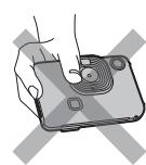
打印时请勿遮盖相纸弹出槽。
